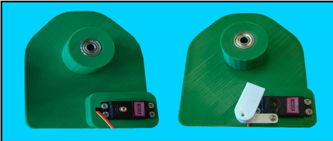
**16)** Ya solo quedaría enroscar el tornillo sinfín de la estructura de los ojos dentro del rodamiento de esta última base 1 (quedando como la imagen de la izquierda) y pegando la pieza 12 a la base 2 para poder dirigirla. Y ahora sí acabamos la construcción quedando como la estructura de la derecha (pusimos unos iris morados combinando así con el resto de la estructura.)
