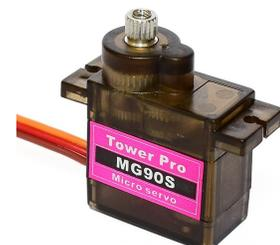
2. El circuito de control integrado en el servomotor compara la señal de control con la posición actual del eje y determina la dirección en la que debe girar para alcanzar la posición deseada.
