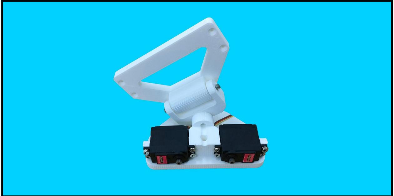
**12)** En este paso, les dotaremos a los dos servos MG996R con brazos bilaterales y los situaremos en 90° para continuar (con la posición que se observa en la imagen). A continuación, en el extremo exterior de los brazos del servo atornillamos las piezas 10 y 11 que se unirán a la base 3 (para así controlar toda la estructura). Los 4 tornillos utilizados en total tenían las cualidades de 2 mm de grosor y 3 cm de largo.
