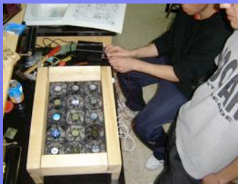
Investigadores montando los ventiladores en la estructura de la mesa de aire
