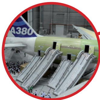
S.O.S Rampa evacuación aérea
