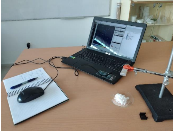
Detección del decaimiento del ^{40}\text{K} de una muestra de KOH
